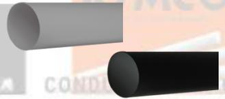
Se fabrica con lámina rollada en caliente para la producción de tubería de acero al carbono mediante un proceso de formado en frío, soldada longitudinalmente por resistencia eléctrica de alta frecuencia, cumpliendo con las normas nacionales e internacionales.
